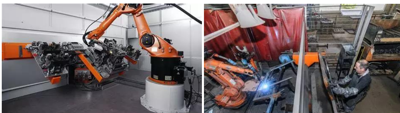
Cellule de soudage robotisée
