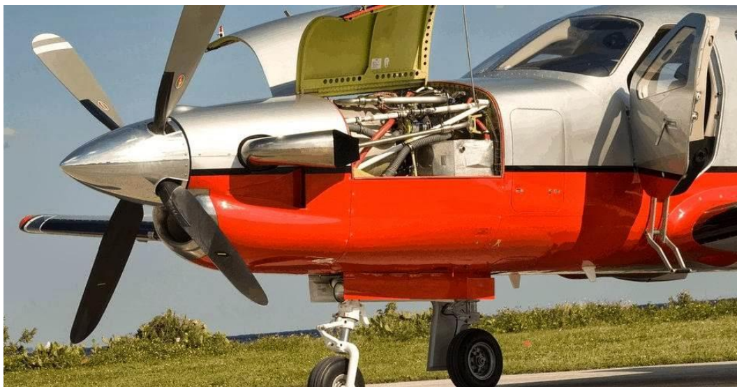
Piquage sur turbine et modification en compartiment moteur
